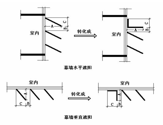
图 A. 0. 4 幕墙遮阳计算示意
